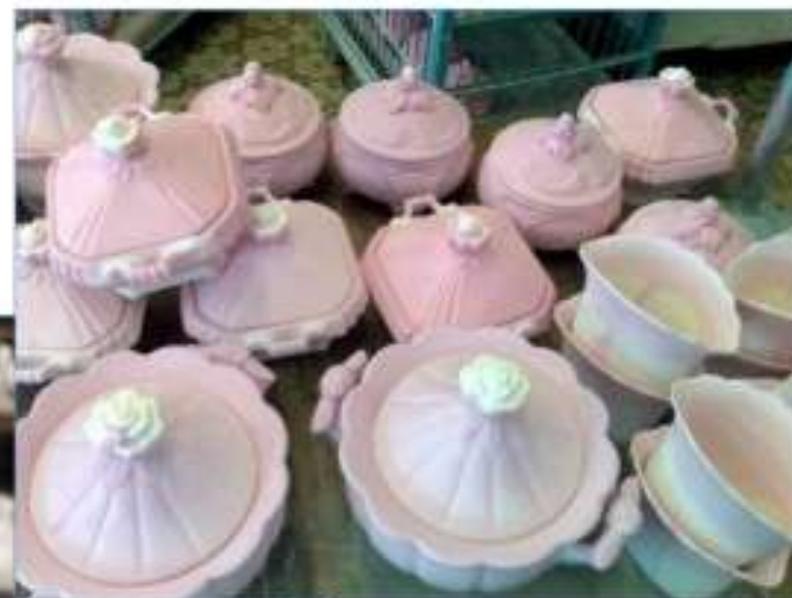
После предварительного обжига изделия проходят «фуксиновый контроль»: полуфабрикаты опускают в розовый нестойкий раствор фуксина, пропадающий под воздействием света. Этот технологический процесс даёт возможность проверить качество керамических изделий, делает заметными мелкие трещинки и сколы.
